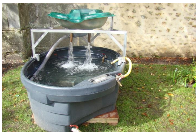
20 Dynamisation sur réservoir ouvert 1000 l (pompe immergée 12 Volt-100 Watts-12 m3/h) Evacuation aérienne du chlore : 15 mn Brassage des substances ajoutées : 20 à 60 mn selon les extraits à brasser
