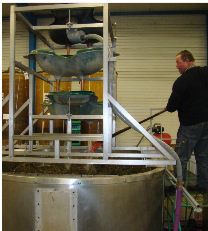
25 Remplissage de cuves avec l'eau de pluie avec « Odyssée Vortex » pour tisanes et macérations
